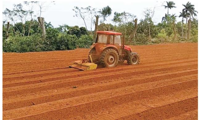
图 2 1GL-180 型木薯旋耕起垄机及垄形效果
